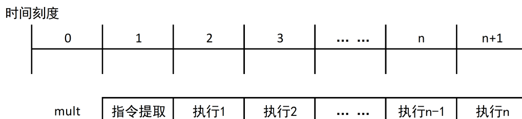
图 2.3: 乘法指令 mult 的执行过程
