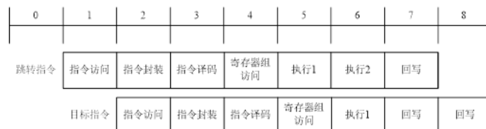
图 6.8: BT, BF 指令预测不跳转且预测正确时执行过程
