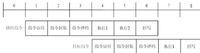
图 6.7: BR, BSR 指令的跳转和 BT, BF 指令预测跳转且预测正确时执行过程
